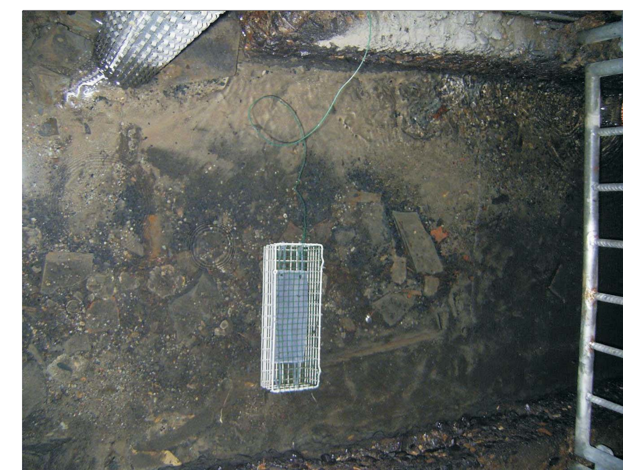
Abb. 3: Passivsammler-Monitoring in einer Sprengstoff-Fabrik.
