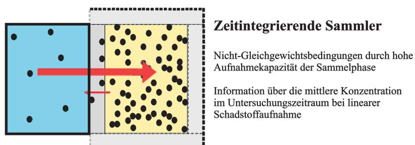
Abb. 2: Funktionsprinzip zeitintegrierender Sammler.
